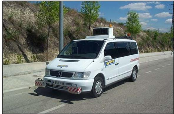
El Vehículo de Medidas Geométricas (V.M.G.), circula a velocidades comprendidas entre los 20 y 80 km/h durante la toma de datos, por lo que no es necesario utilizar vehículos escolta o de señalización. Está señalizado con una barra de luces halógenas y giratorias en la parte superior trasera, supervisado por la Dirección General de Tráfico.
