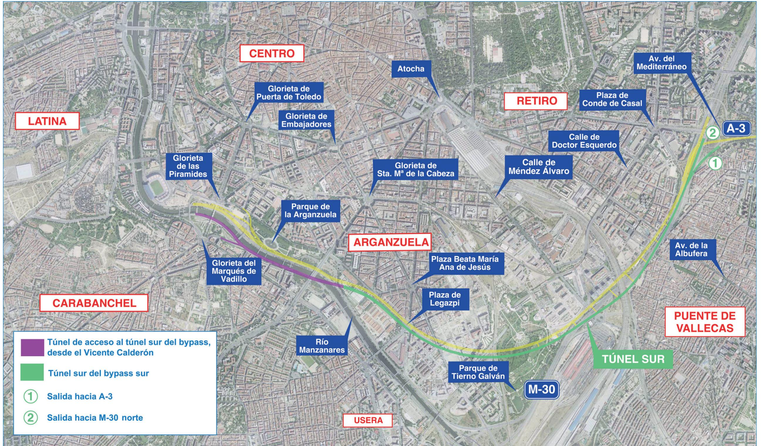
Bypass sur y conexiones del túnel sur con la A-3 y con el tramo soterrado a lo largo de la margen derecha del río Manzanares.
