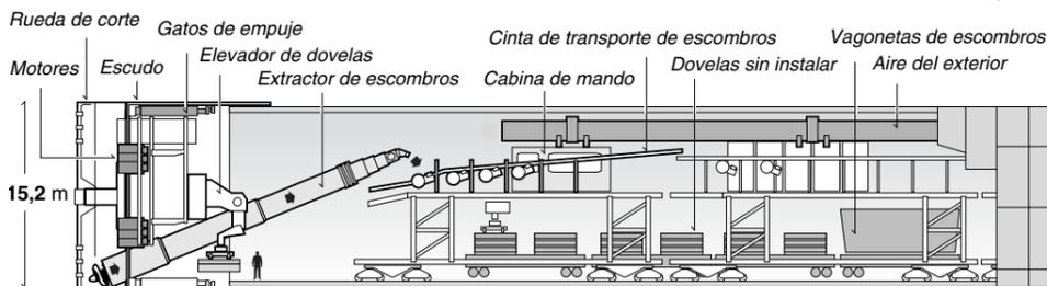
La tuneladora tiene una longitud de 188 m. Tras de sí va extendiendo vías para las vagonetas de transporte y cables auxiliares.
