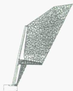
Fig. 9-6. Muro con plataforma estabilizadora (TENSITER)
