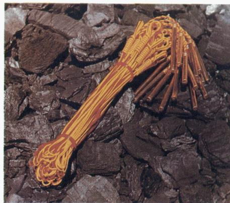
Foto 6.32.- Detonadores especiales para empleo en ambientes grisusos o inflamables (Cortesía de U.E.E.)
