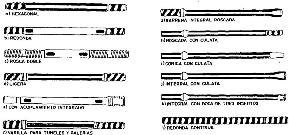
Fig. 5.27.- Tipos de varillas
