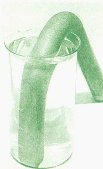
Foto 6.2.- Ejemplo de la resistencia al agua de riogel 2 (Cortesía de U.E.E.)
