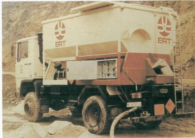
Foto 6.8.- Camión cargador de nagolita a granel en barrenos a cielo abierto de gran calibre (Cortesía de U.E.E)
