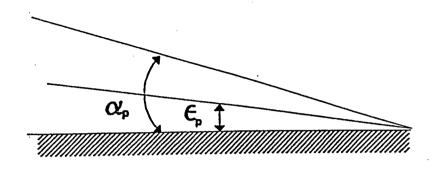
Fig. 1.- Condiciones geométricas de medida
