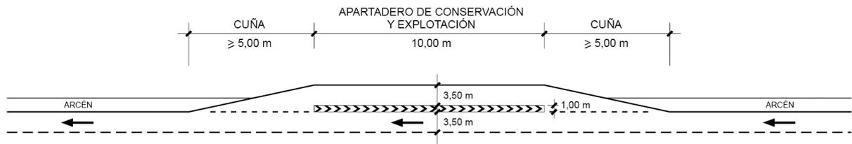
No obstante, en determinados casos, las dimensiones mínimas de los apartaderos de conservación y explotación pueden resultar insuficientes para la detención de vehículos de dimensiones superiores a los diez metros (10 m) de longitud en condiciones suficientes de seguridad.
