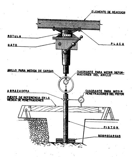
C.B.R. "IN SITU". ESQUEMA DE LA DISPOSICION DE LOS APARATOS
