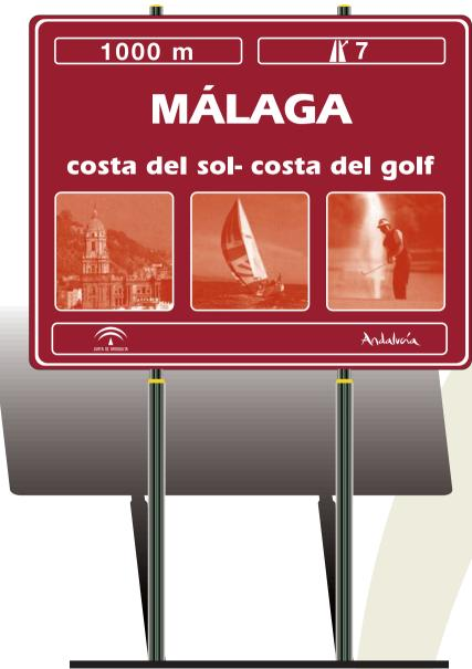
Estos paneles permiten la señalización de los recursos específicos de una determinada zona. Estos paneles están emplazados en las vías principales de tráfico rodado y se utilizan las principales de tranco rodado y se difilizar has ilustraciones con realismo fotográfico para su realización, pues el empleo de pictogramas básicos podría resultar confuso y no ajustado a la correcta interpretación. Se representan recursos naturales, deportivos, monumentales, gastronómicos....
