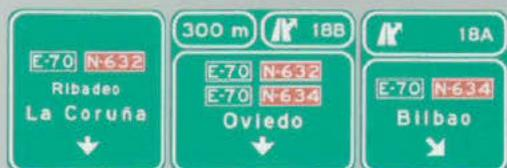
Señales sobre la calzada en vía rápida. Dos salidas inmediatas muy próximas hacia vía rápida y dirección propia
