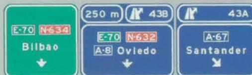
Señales sobre la calzada en vía rápida. Dos salidas inmediatas muy próximas hacia autopista o autovía y dirección propia
