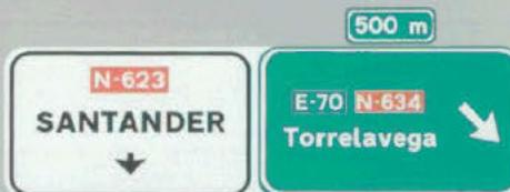
Preseñalización con señales sobre la calzada en carretera convencional hacia vía rápida y dirección propia
