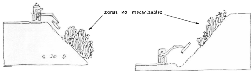
Fig. 45. Mantenimiento de las zonas superior e inferior de grandes taludes
