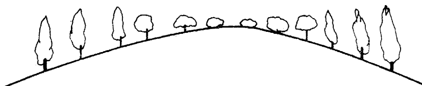
Fig. 4. Plantación en cambio de rasante (Alzado)
