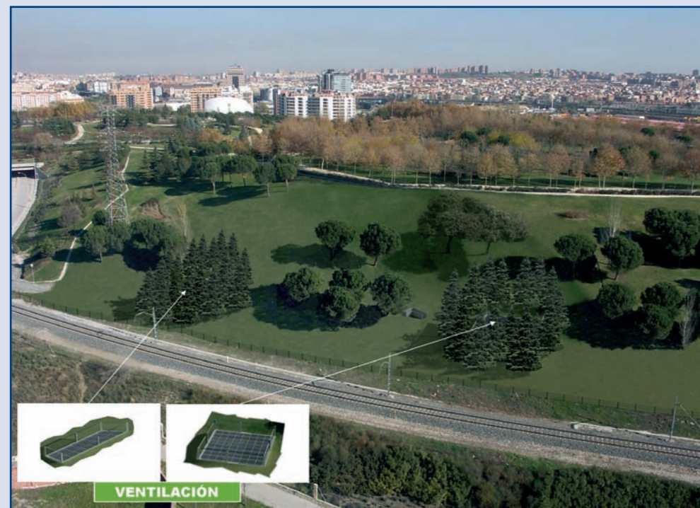
▲ Recreación virtual de la ventilación de los túneles en el parque Tierno Galván e integración en el paisaje.
